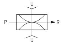
P=CONNESSIONE ARIA COMPRESSA      R=SCARICO      U=CONNESSIONE VUOTO
